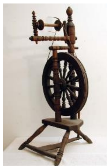
Kolovrat – zařízení na spřádání příze
